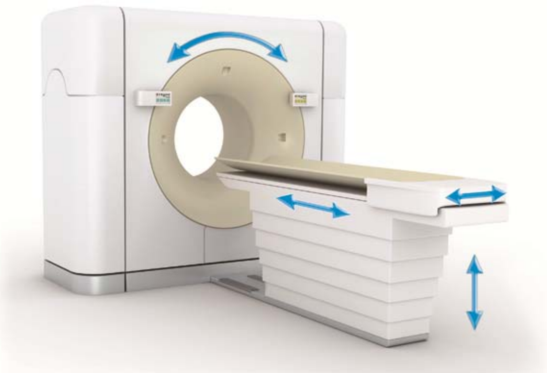
Abbildung 15: Rotative- sowie Längenmessung an einem Tomographen
