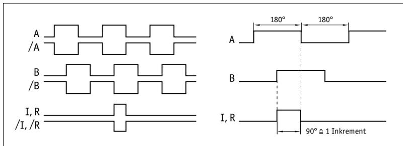
**!** L'état logique des signaux A et B n'est pas défini en rapport au signal index 1 ou signal de référence. Il peut être différent de représentation du signal.
