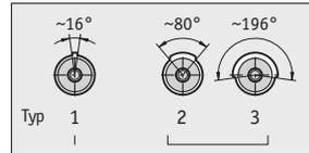
Angolo di commutazione delle tre camme di comando: specialmente per la delimitazione delle posizioni finali (1), per le funzioni di comando (2, 3).
