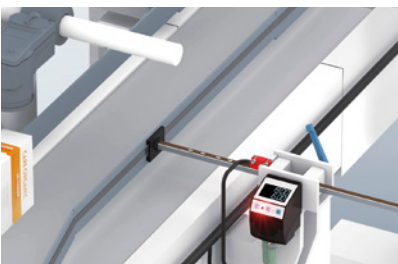
Guiado lateral supervisado en máquinas de envasado
