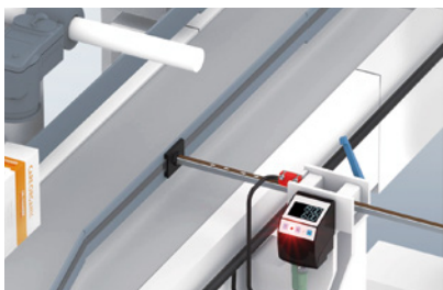
Guida laterale monitorata nelle macchine per l'imballaggio
