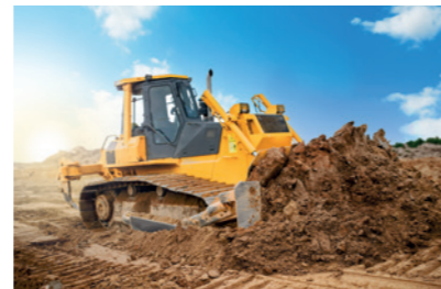
Zylinderintegrierte Sensoren sorgen für optimales Planieren und für automatisierte Schildpositionierung in Planierraupen
