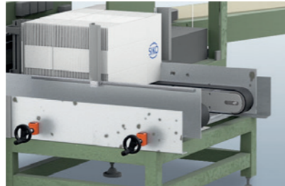
Reproduzierbare Einstellung von Kartonagenaufrichtern
